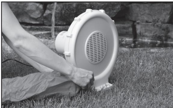
Conecte um ventilador(es) na longa entrada e prenda seguramente. (Se o seu insuflável tem um tubo de saída, prenda este fecho antes de insuflar). Use apenas o ventilador fornecido com seu insuflável, ou um ventilador fabricado para substituição para evitar danos e possíveis ferimentos.
