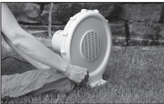
Reliez la (les) soufflerie(s) au long conduit et serrez adéquatement. (Si votre structure gonflable a un tube de sortie, fermez-le bien avant de commencer le gonflement). Utilisez uniquement la soufflerie fournie avec votre structure gonflable ou une soufflerie de remplacement spécifiée par le fabricant afin d'éviter de possibles dégâts et blessures.
