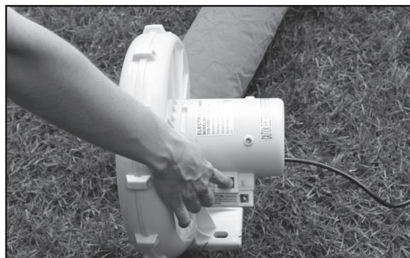
Een GFCI toestel moet gebruikt worden (indien uw blazer dit nog niet bevat). Gebruik geen verlengsnoer om uw blazer met stroom te voorzien. Hou de blazer en de verlengsnoer weg van water. Sluit het aan en start de blazer; uw eenheid zal zich in enkele minuten opblazen. U moet de blazer aan laten gedurende de gehele tijd dat u het opblaasbaar toestel wilt gebruiken. U zal lucht horen "ademen" uit de naden van de stof. Dit is opzettelijk om lucht te laten ontsnappen.
